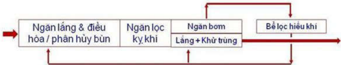
Hình 3.2: Sơ đồ nguyên lý hoạt động của bể Bastafat-f
